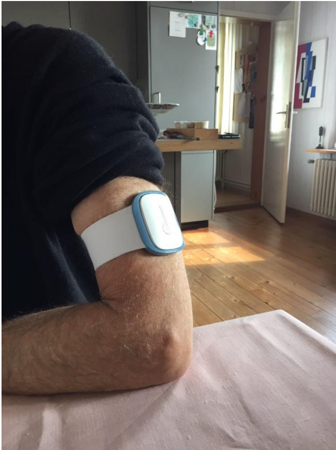
Anlegen des Oberarmsensors bei einer Testperson
